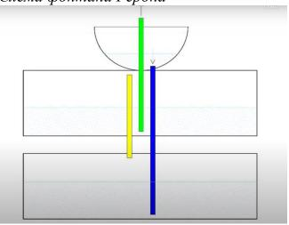
Фонтан Герона может работать очень долго, но емкости приходится менять местами. Потому что нижняя постепенно наполняется водой, а верхняя - воздухом, а значит, перестает создаваться нужное давление.
